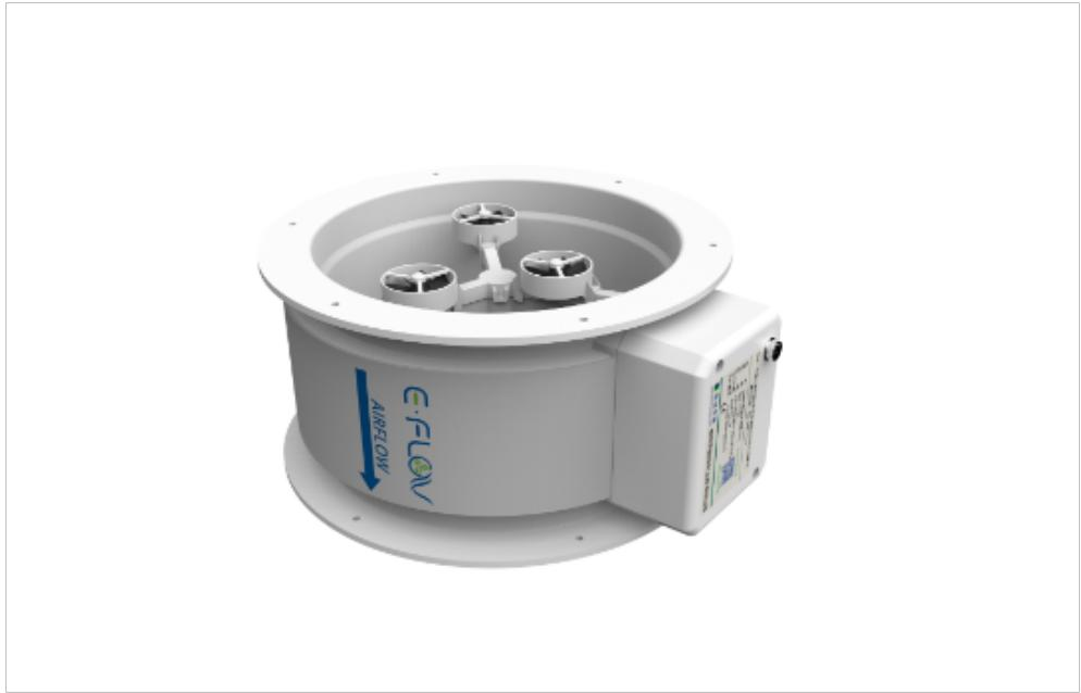
智能风阀改变了风量控制的模式，使得风量控制更加的稳定和精确，阀门的压力无关性，对于风管中压力波动能作出极快的响应，保证风量控制的稳定性，应用在对风量需要精确控制的场所，智能风阀是高精度、快速反应，与压力变化无关，采用快速直线行程电动执行器驱动的风量控制设备；具有不受风管内静压变化影响，特有的阀芯组件，内置精密的不锈钢弹簧，当风管内压力变化时，通过阀芯位置的改变来保持一个恒定的风量。它的众多特性赋予了实验室控制系统在排风柜和实验室控制方面良好的性能，变风量系统中，智能风阀具有不受风管内静压变化影响，当风管内压力变化时，通过阀芯位置的改变来保持一个恒定的风量。收到控制器提供一个控制命令信号之后，便被迅速调节到相应的风量。只要风管的压力在变风量智能风阀的工作范围内，智能风阀便会精确的控制风量。智能风阀叶轮流量计组件以卡扣式安装的新型结构形式设计制造的，方便清洗更换。辽宁直通式智能风阀厂家直供
